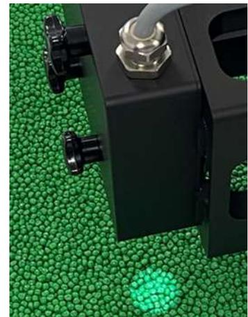
측정기로 같은 재료의 플라스틱 플레이트에서 얻어낸 측정값과 동일한  $L^*a^*b^*$  값들을 표시합니다. 즉, 인라인 측정 시스템에서 우리는 휴대용 측정기의  $L^*a^*b^*$  값에 따른다고 말할 수 있습니다. 측정값의 표시 및 저장 시에도 DOCAL Scope V1.4 소프트웨어는 마찬가지로 우수한 서비스를 제공합니다. 현장의 설비 조작자에게는 트렌드 표시 및 허용 오차 표시가 큰 도움이 될 것입니다. 이를 관찰하면서 무언가 “잘못된 경우” 재빠른 조치를 취하여 악화를 방지할 수 있기 때문입니다.
